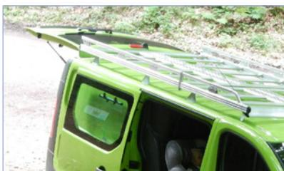
Für Fahrzeuge mit Heckklappen sind spezielle Dachträger nötig, damit das vollständige Öffnen möglich bleibt.
